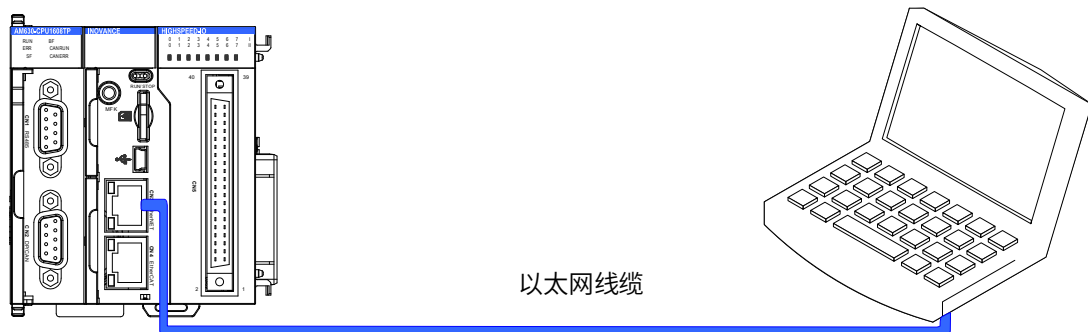
图 5-29 CPU 模块与 PC 连接
