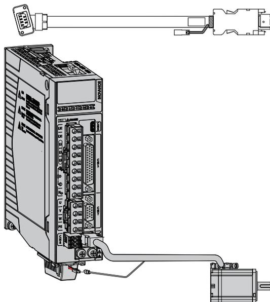
图5-3 绝对值编码器信号<sup>[1]</sup>接线示例图
