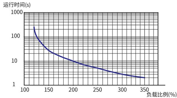
图3-3 MS1H1和MS1H4系列电机过载曲线
