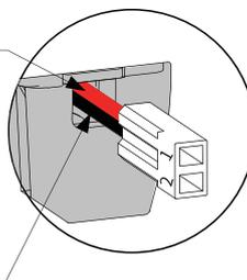
图5-4 绝对值编码器电池外引线说明
