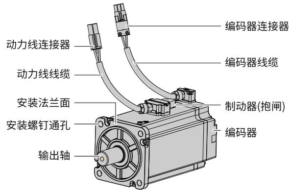
图2-3 甩线型伺服电机部件说明示意图
