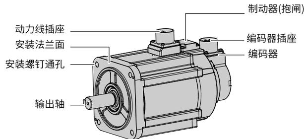
图2-4 伺服电机 (100/130/180机座) 部件说明示意图
