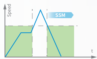
SSM 安全速度监视 Safe Speed Monitor 输出一个安全信号指示电机速度是否低于特定限值
